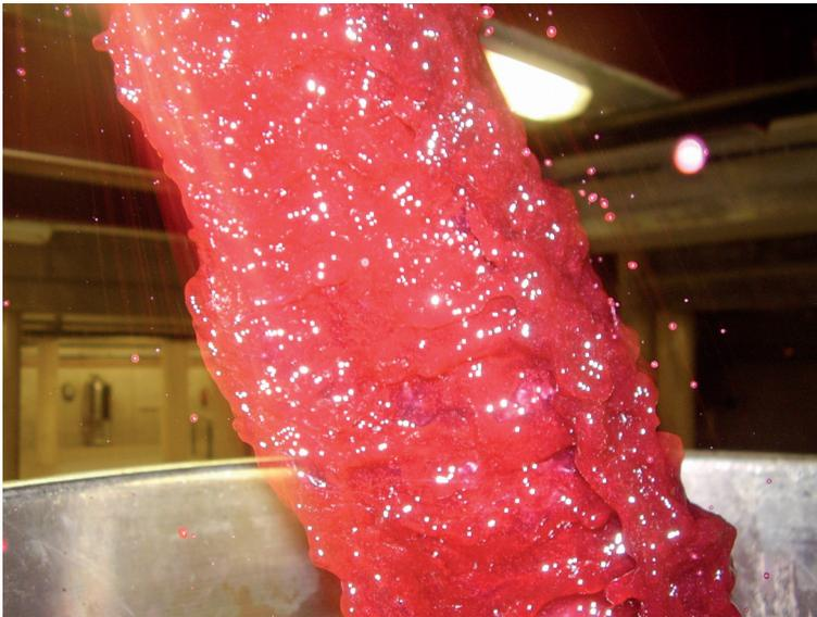
La duración de un remontado se calcula de acuerdo con el contenido del depósito a remontar. Está admitido que el bombeo de un tercio o la mitad de un mosto de la cuba es un volumen necesario y suficiente. El número y volumen varía según la etapa de fermentación. Siendo más intensos en las primeras fases de la fermentación.
