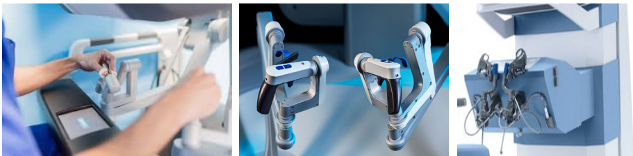
Figura 16. Tipos de Mandos: anillo, joystick, laparoscópicos.
