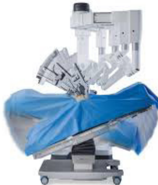
Figura 13. Table Motion®. Mesa Integrada con Robot da Vinci Xi.
